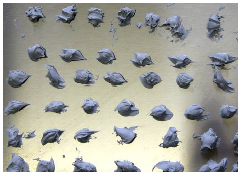
Vorbereitete Materialproben für Test nach ISO 846
