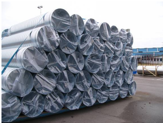
Transportgerecht verschlossene Rohrenden
