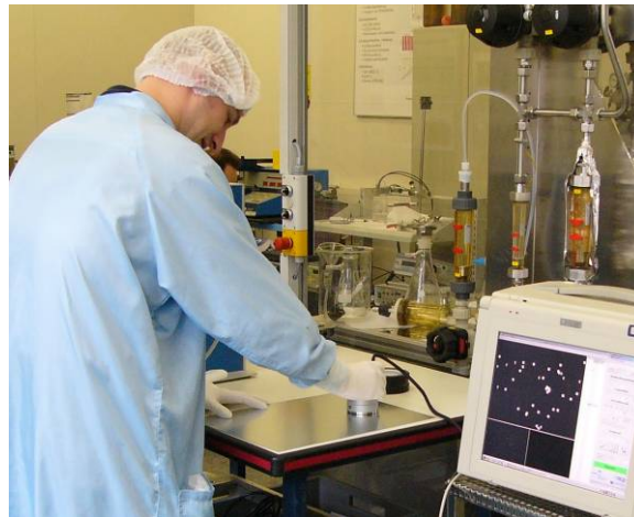
Reinigbarkeitsuntersuchung mit dem Meßgerät ParticleGuard beim Fraunhofer IPA
