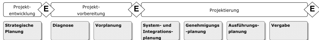
Abbildung 3: Stufen- und Phasen der Objektplanung mit Entscheiden [ifib]
